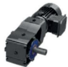
Cárter 92.1, brida B14, eje macizo, motor integrado
