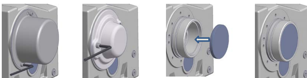
Εικόνα 14: Συναρμολόγηση του καλύμματος επιλογή SH, επιλογή H και επιλογή H66
