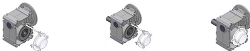
Εικόνα 15: Αποσυναρμολόγηση και συναρμολόγηση του καλύμματος
