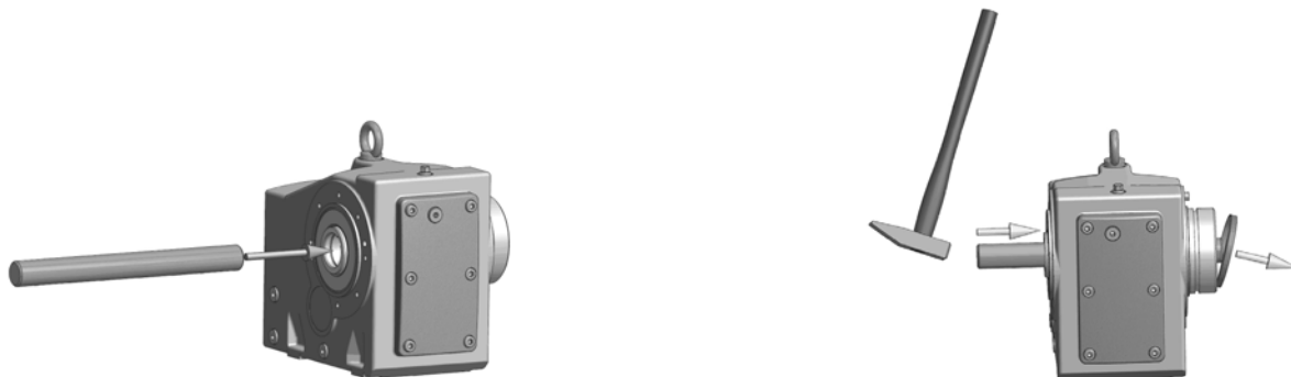
Εικόνα 5: Αποσυναρμολόγηση του καλύμματος ασφάλισης που έχει τοποθετηθεί από το εργοστάσιο
