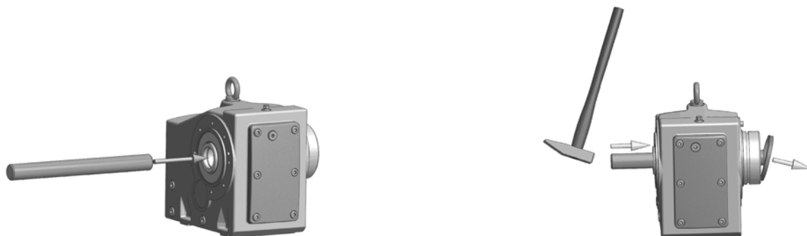
插图 5：拆卸制造商已安装的密封盖
