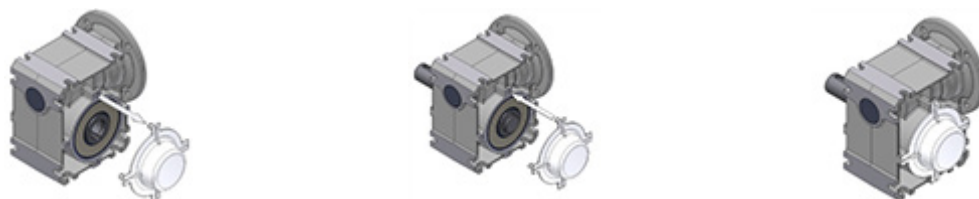
Figura 15: Demontarea și montarea capacului de acoperire
