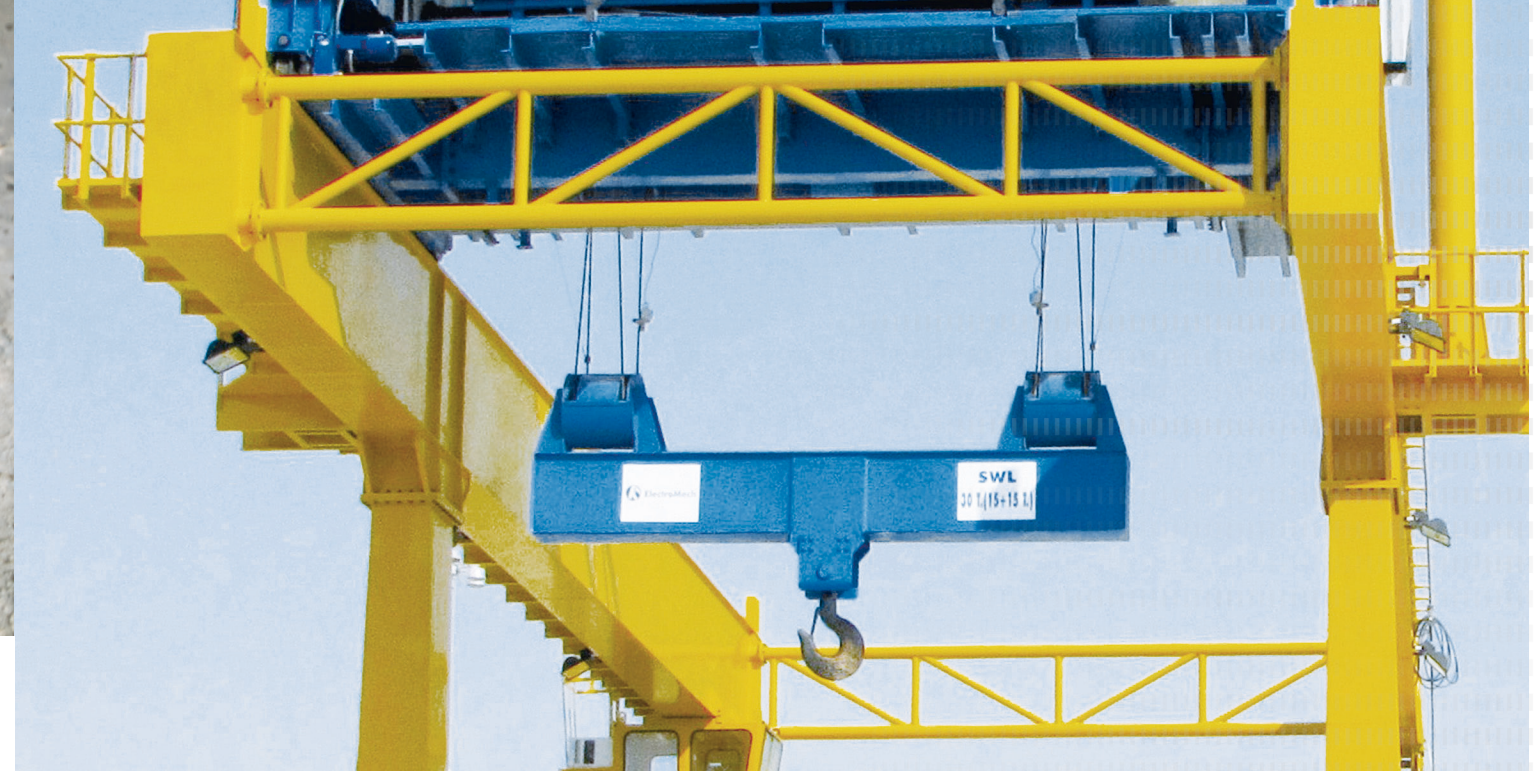
In Abu Dhabi werden bis zu 100 m tief unter der Stadt Tunnel für neue Abwasserkanäle angelegt. Exakt synchronisierte, robuste NORD-Antriebe bewegen Hubwerke zum Absenken und Heben der Versorgungsplattformen an den Tunnel-Zugangsschächten.
