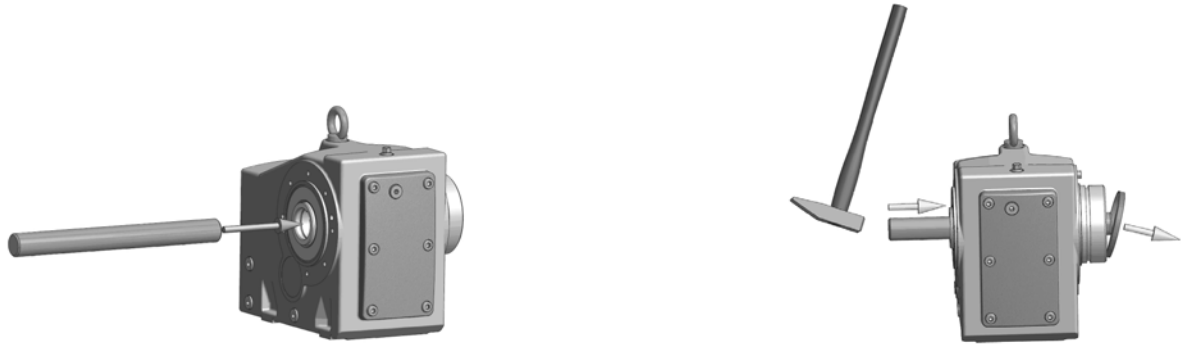
插图 5: 拆卸制造商已安装的密合盖
