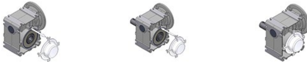
插图 14: 拆卸或安装防护罩
