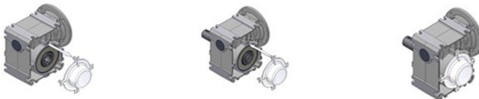
Slika 14: Demontaža i montaža pokrovne kape
