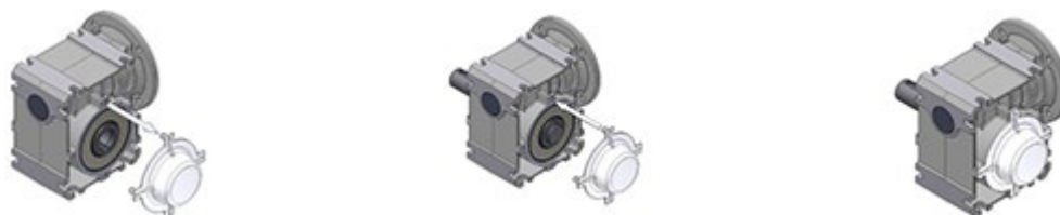
Figura 15: Demontarea și montarea capacului de acoperire
