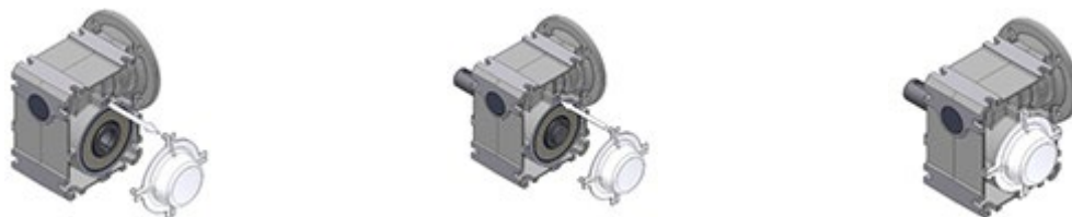
Фигура 15: Демонтаж и монтаж на предпазния капак
