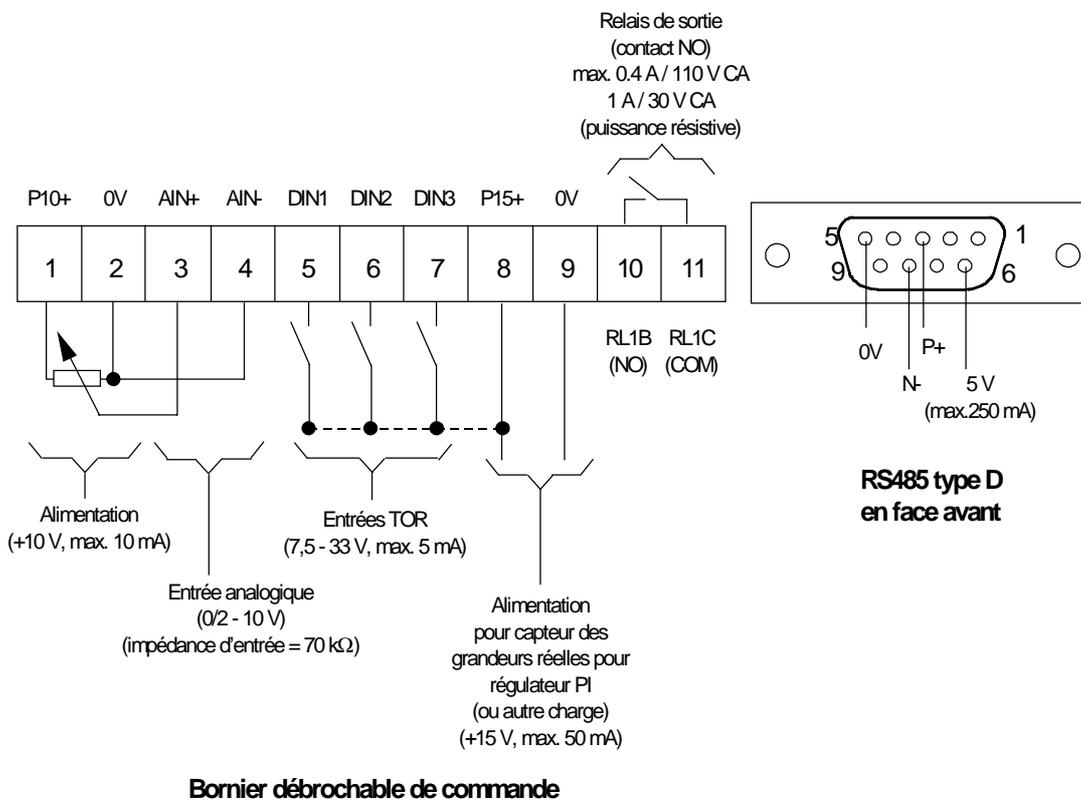
Figure 6: Branchement des circuits de commande
