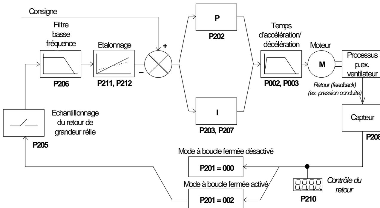
Figure 11: Commande à boucle fermée
