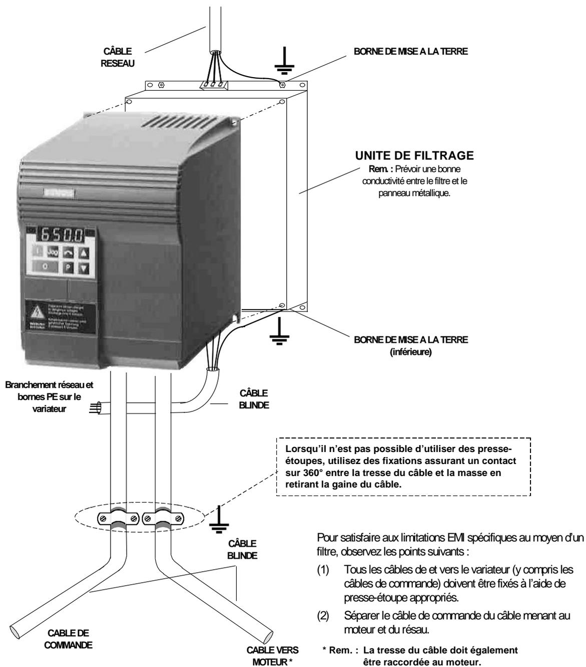
Figure 1: Exemple d'installation d'un filtre de suppression RFI
