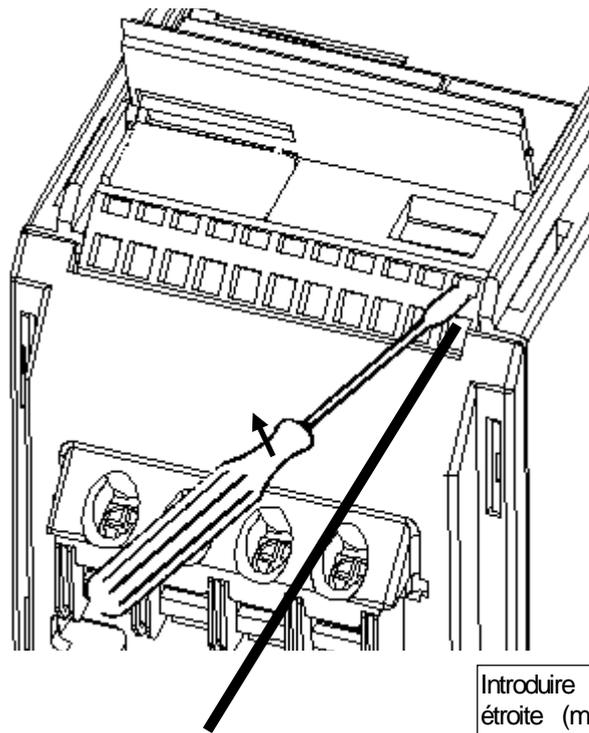
Introduire un tournevis à lame étroite (max. 3,5 mm) comme indiqué tout en introduisant le câble de commande par le bas.
