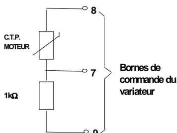
Figure 7: Raccordement d'une sonde CTP contre la surcharge du moteur.
