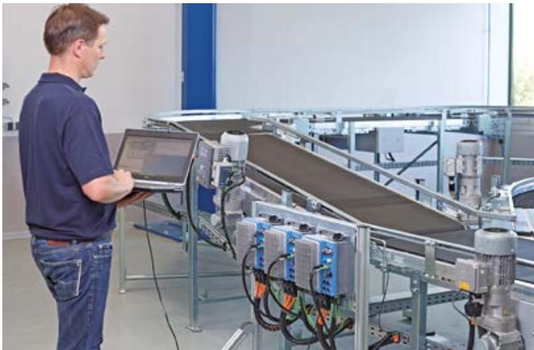
I trasporti industriali e l'intralogistica richiedono sistemi di azionamento di semplice installazione e di facile accesso durante l'esercizio e in caso di manutenzione. L'inverter NORDAC *LINK* completa la gamma di prodotti NORD DRIVESYSTEMS e offre ai clienti un comando dell'azionamento per un'installazione flessibile in prossimità del motore. Le soluzioni di azionamento decentralizzate possono ridurre in misura significativa i costi d'impianto.
